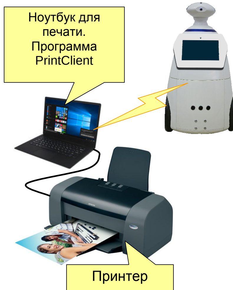
Рис. 7 Иллюстрация подключения фотопринера к Робототехническому Комплексу
