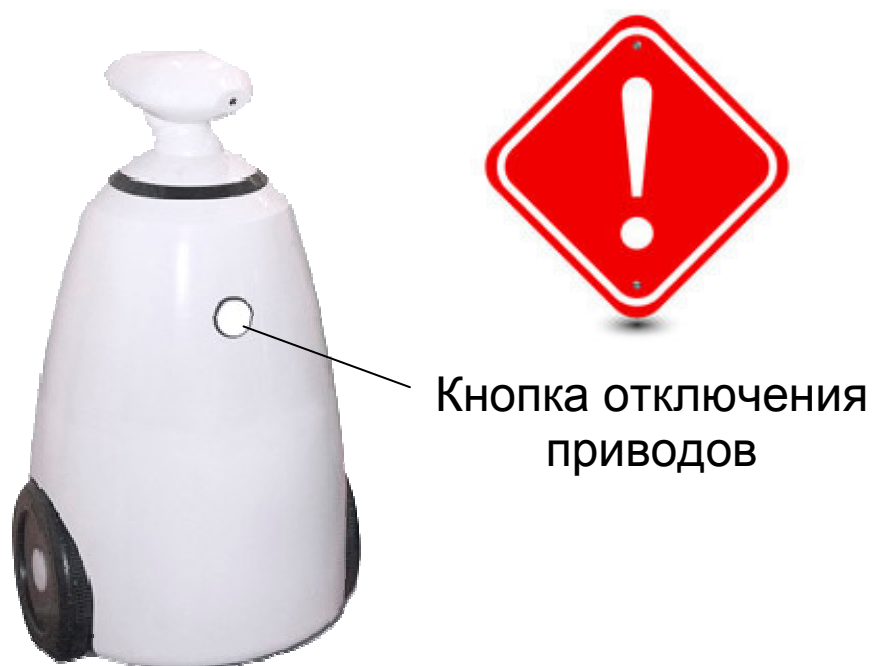
Рис. 2 Нахождение кнопки аварийного отключения приводов
