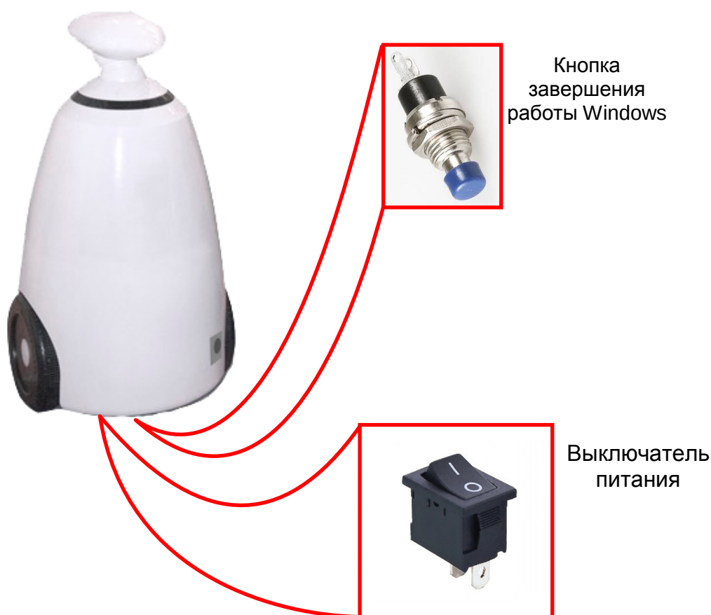
Рис. 1 Местонахождение выключателя питания и кнопки завершения работы Windows
